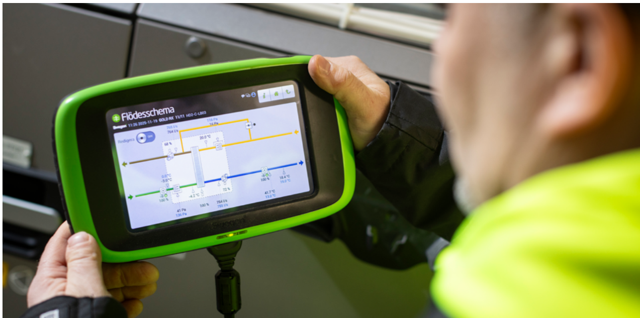
Mätinstrumentet visar flöden och temperaturer i fastigheten i realtid.
